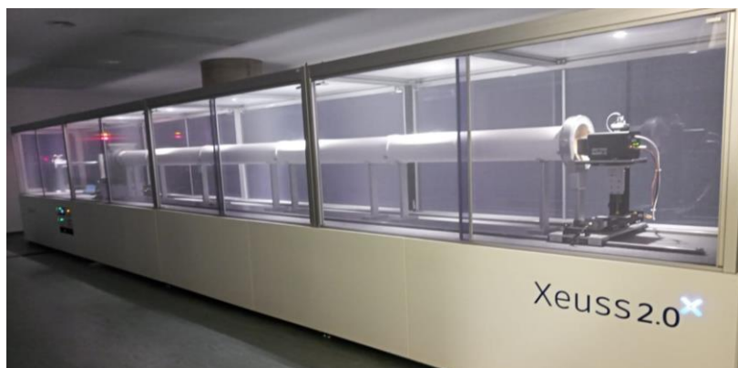
Figura 1. Equipo de SAXS-USAXS XENOS modelo Xeuss 2.0 con medición simultánea de WAXS del Laboratorio de Cristalografía Aplicada, ITECA, CONICET-UNSAM (San Martín, Gran Buenos Aires).
