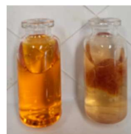
Figura 2. Testigo inicial (izq) y estado final de una solución de naranja de metilo en contacto con la esponja s/absorbente durante 1 hora.
